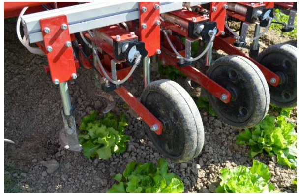
Abb. 1: Der Hackroboter von Steketee arbeitet mit kameragesteuerten Sichelmessern (Foto M. Scheidiger)
